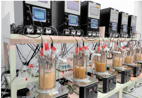
▲ジャーフェメンターを用いて植物希少成分を大腸菌で発酵生産させている様子
