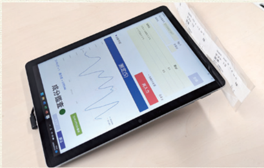
▲分光分析を用いた薬剤識別装置「コナミル」。見た目は同じ白い粉薬の成分を瞬時に鑑査可能。
