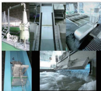
図2 開発した機器 (酸素供給器、マイクロスクリーン、循環ポンプ、沈殿物排除装置、造波ゲート)
