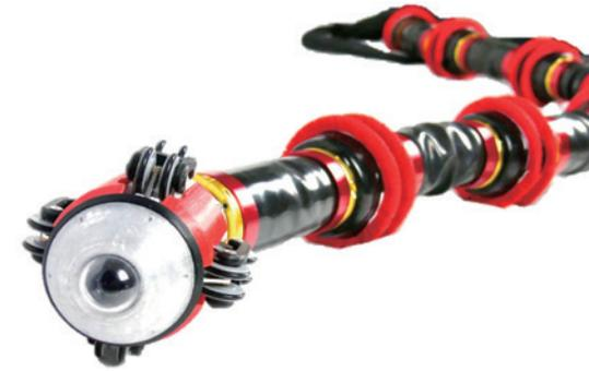
▲ミミズ型下水管検査ロボット
