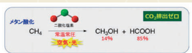
図1 二酸化塩素によるバイオガス中に含まれるメタン酸化の反応式。
