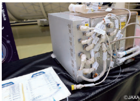
水再生システムの 国際宇宙ステーション (ISS) 実証装置
