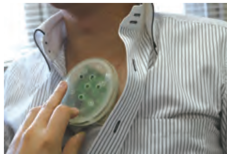
胸にあてることで心電、心音を計測できる超聴診器。
