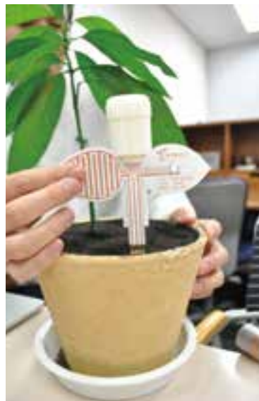
一般向けに開発したSenSprout。印刷エレクトロニクス技術を活かし、根に当たる部分で土壌内の水分量を測り、LEDで水分量を知らせる。プロ農家向けの製品は無線にも対応。
