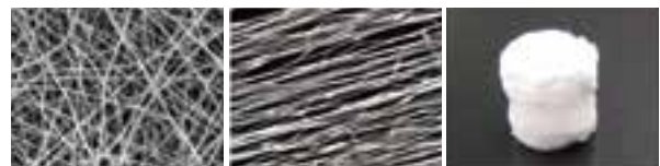
図1) ナノファイバーでつくった不織布(左)、配向シート(中央)、スポンジ(右)
