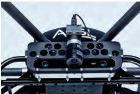
ACSLの機体に搭載されているステレオカメラと単眼カメラ
