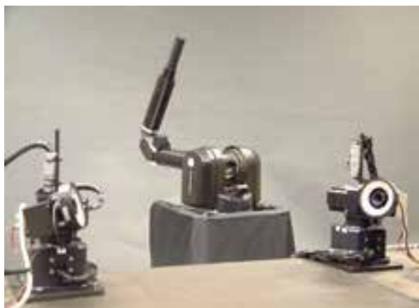
投げられたボールを100%打ち返すバッティングロボットアーム。手前にある超高速ビジョンセンサーを搭載したカメラユニットで、ボールの位置を正確に捉えている。
