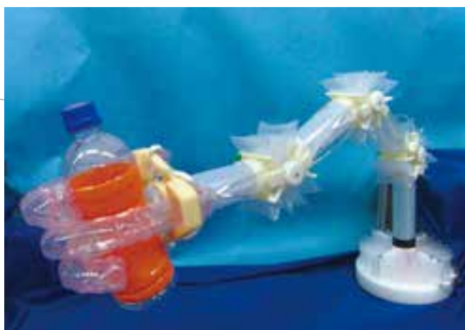
ポリエチレンとプラスチックで作られた ロボットアーム
