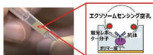
図2. エクソソームセンシングチップのイメージ。ポストインプリンティング修飾により、抗体と蛍光分子を導入することで、分子認識能を向上させたバイオセンサを実現した。
