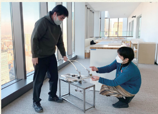
▲現在は、持ちやすく、犬にも負担をかけない盲導犬用ハーネスを開発中。盲導犬の歩行状態を再現する装置を制作し、テストを入念に行っている。
